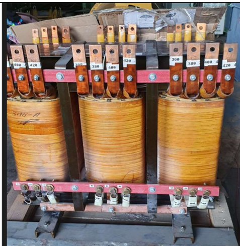
SỬA CHỮA CUỘN KHÁNG KHÔ REPAIR OF DRY RESISTANT ROLL
