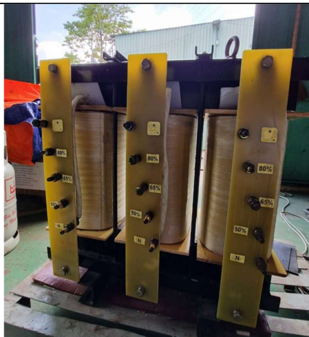
SỬA CHỮA CUỘN KHÁNG KHÔ REPAIR OF DRY RESISTANT ROLL
