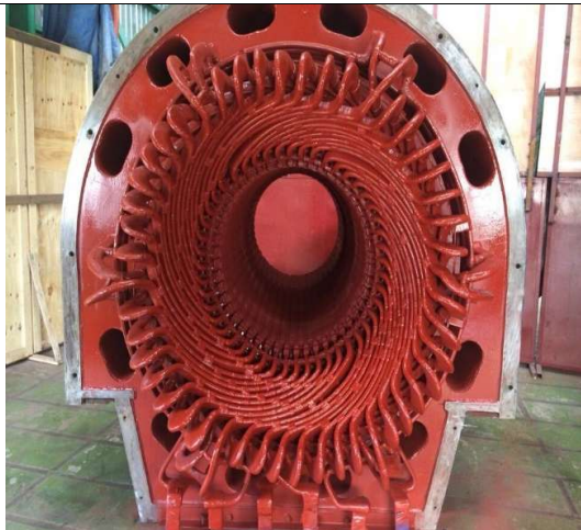
SỬA CHỮA QUẤN LẠI MÁY PHÁT ĐIỆN 4000KVA – 6.6KV REPAIR AND REWINDING OF GENERATOR 4000KVA – 6.6KV
