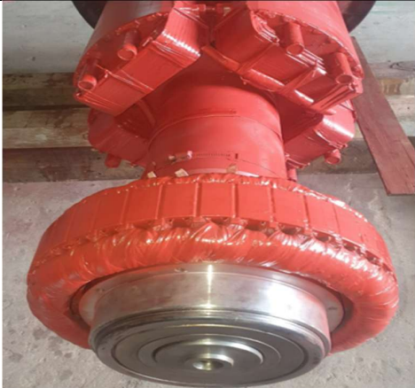
SỬA CHỮA MÁY KÍCH TỪ MÁY PHÁT 4000VA CHO GIÀN KHOAN DẦU KHÍ REPAIR OF 4000VA GENERATOR EXCITATION FOR OIL AND GAS DRILLING RIG
