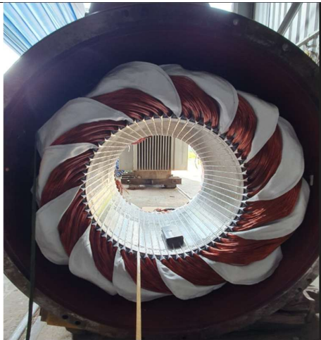
SỬA CHỮA QUẤN LẠI MÁY PHÁT ĐIỆN HIỆU CAT 1500KVA – 0,4KV REPAIR AND REWINDING OF CAT BRAND GENERATOR 1500KVA – 0.4KV
