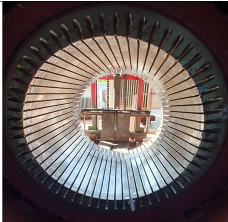
SỬA CHỮA QUẤN STATOR MÁY PHÁT 1250KVA – 6,6KV NHÀ MÁY THỦY ĐIỆN BÙ CÀ MAU REPAIR OF STATOR WINDING GENERATOR 1250KVA – 6.6KV BU CA MAU HYDROPOWER PLANT
