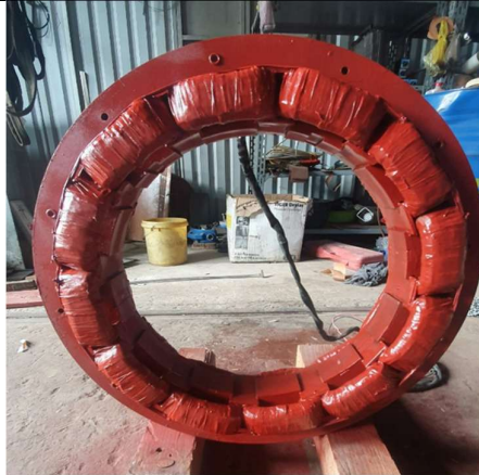
SỬA CHỮA MÁY KÍCH TỪ MÁY PHÁT 4000VA CHO GIÀN KHOAN DẦU KHÍ REPAIR OF 4000VA GENERATOR EXCITATION FOR OIL AND GAS DRILLING RIG
